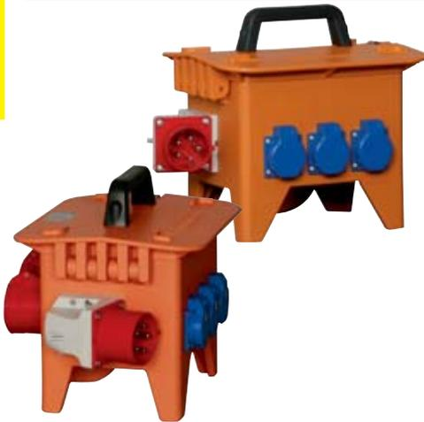
**Ausführung:** Gehäuse aus **Vollgummi** in RAL 2000, gelborange • Schlagfest, schutzisoliert, spritzwassergeschützt in Schutzart **IP44** • Gehäuse wetter- und alterungsbeständig, formstabil • Hohe Säuren- und Laugenresistenz, stapelbar • RCD- und LS-Schalter sicher • geschützt hinter anschnarntem Gehäusedeckel mit Edelstahl-Schnellverschlüssen • Nach **DIN EN 61439-1 und 4** (VDE 0660-600-1 und 4)
