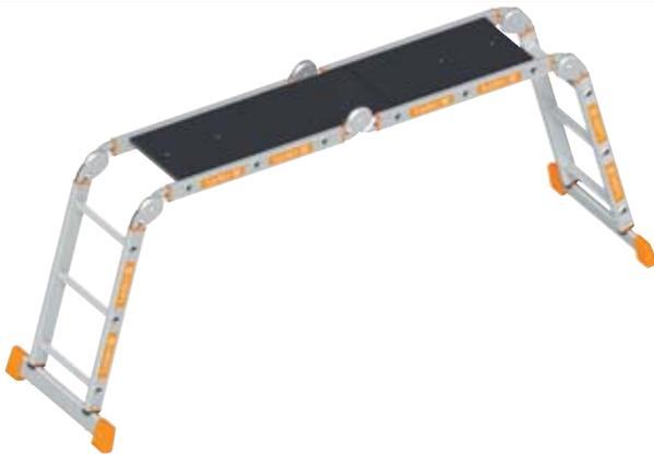
**Ausführung:** Aluminium-Kofferraumleiter • **Inklusive Plattform** • Kleinste Transport- und Lagermaße • Einsetzbar als Stehleiter, Anlegeleiter, Anlegeleiter mit Wandabstand und als Arbeitsbühne (nur mit Auflage) • Sicherheitsgelenke automatisch einrastend, mit leichtem Druck zu lösen • **Transportmaße:** 1,03 x 0,40 x 0,29 m
