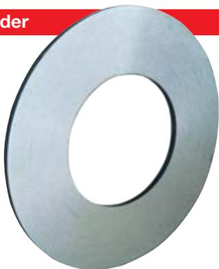
**Ausführung:** Aus kaltgewalztem Kohlenstoffstahl in Spezialgüte • Gewachst und gebläut • Entspricht der Qualitätsstufe II • Geringen Rostschutz • Die Kanten sind arrondiert
