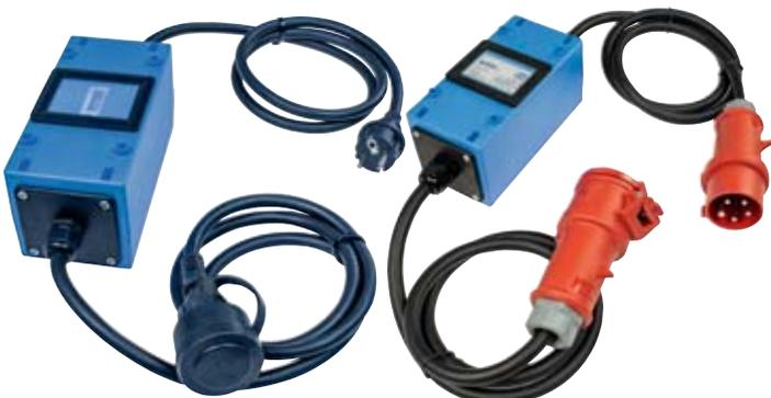
**Ausführung:** Mit Rollenzählwerk, MID geeicht und verplombt • Gehäuse aus hochbruchfestem Spezialkunststoff • Rollenzählwerk nicht auf 0 rückstellbar • Mit schwerer Gummischlauchleitung H07RN-F • Analoges Display • Anzeige für max. 99.999,9 kWh • Genauigkeitsklasse 1/B • Fremdkörper- und spritzwassergeschützt • Zugelassen für Baustellen und landwirtschaftliche Betriebe • Geprüft nach: DIN EN 50525-2, DIN VDE 0620-2-1 IEC 60309 IEC EN 50470-1
