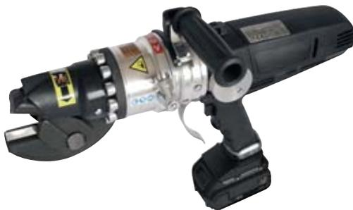
**Ausführung:** Schneidet bis 16 mm Betonstahl/Baustahlmatten • Schnittgeschwindigkeit ca. 1 bis 3 Sek. • Rückstellventil für sicheres, anwenderfreundliches Schneiden • 360° drehbarer Schneidekopf • Ca. 125-150 Schnitte pro Akkuladung
