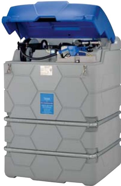
**Ausführung:** Mit integrierter Auffangwanne • Optische Leckageanzeige • Befüllanschluss mit 2" Trockenkupplung • Überfüllsicherung • Entlüftungsklappe • Füllstandsanzeiger • Elektrische Pumpe 230 V, 35 l/min • Automatik Zapfpistole und Zapfpistolenhalter
