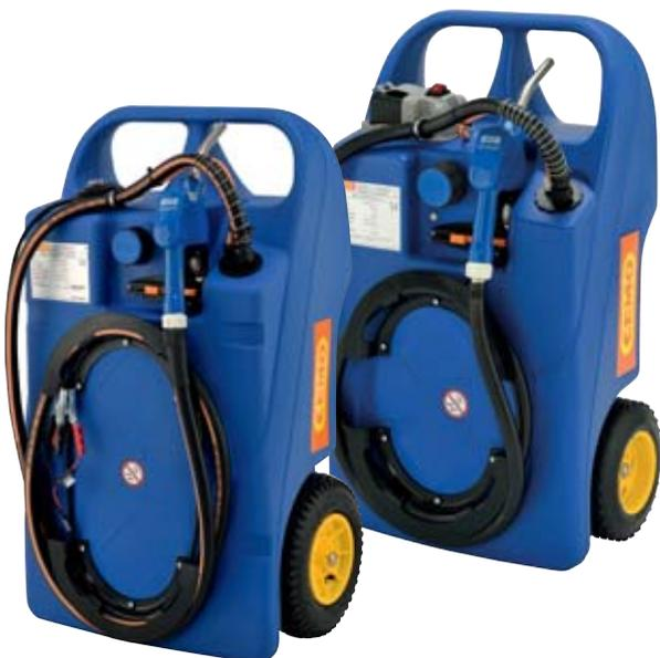
**Ausführung:** Behälter aus geprüfem Polyethylen mit integriertem Handgriff und Tragegriffen • Große Räder für einfaches Handling (Trolley 60 l: Ø 240 mm, Trolley 100 l: luftbereifte Räder Ø 300 mm) • Integrierte Schwallwand • Niedriger Schwerpunkt • Trolley 100 l: Vertiefungen zur Befestigung mit Ratschen-Zurrigurt für den Transport
