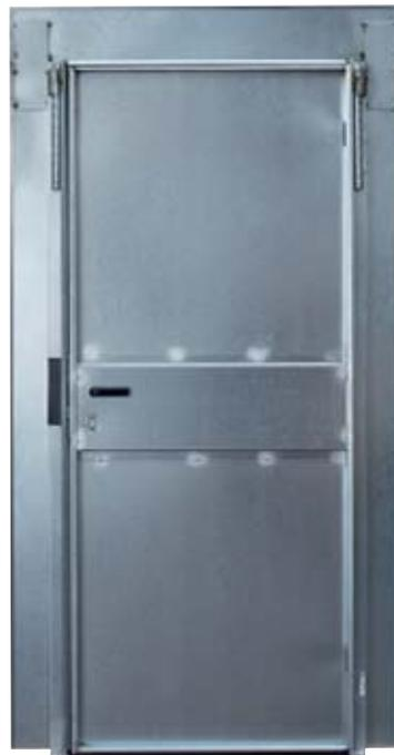
**Ausführung:** Widerstandsklasse 2 (RC2) oder 3 (RC3) • Türblatt aus dickwandigem Stahlblech (massiv) • TÜV geprüft • Aufbruchssicherung durch Zargenumgriff • Mit ABUS Profilzylinder, kann nicht gezogen werden • Verzinktes Stahlblech mit rostfreien Schweissnähten
