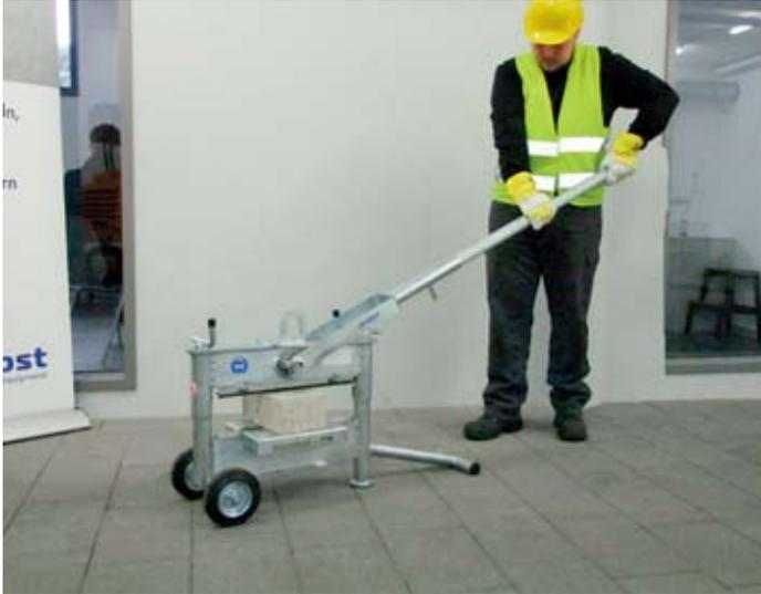
**Ausführung:** Mit Dreikant-Wendemesser • Abgefederter Auflagetisch, beide Hälften neigbar • Maßindikator in cm und inch sowie 45 Grad Winkel auf beiden Auflageblechen • Galvanisch verzinkt
