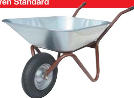
**Ausführung:** Mit nahtlos gezogener verzinkter Mulde • Muldenrand mit ganzer Rundeiseneinlage verstärkt • Stahlfelge • **Tragfähigkeit 200 kg** • Mit Stahlblechboden • Kugellagerrad
