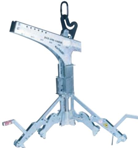
**Ausführung:** Mit verschleißfreier **Wechselautomatik**, kein Bediener notwendig um von „Greifen“ auf „Lösen“ umzuschalten • **Zwei Greiferebenen**, keine Umstellung beim Greifen von Schachtringen und Konen notwendig • Mit nachspannenden Stahlgreifpratzen • Galvanisch verzinkt • **Stufenweise einstellbar:** 625 / 700 / 800 / 1000 / 1050 / 1200 / 1250 / 1350 / 1500 mm
