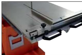
**Ausführung:** Automatische Bandabschaltung am Schnittende • Trockenschnitt mit minimaler Staubentwicklung • Galvanisierter und klappbarer Schneidisch • Transportöse, zwei Staplertaschen und Transporträder
