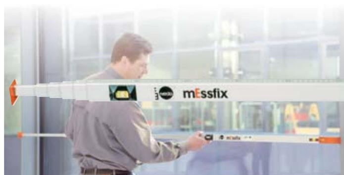
**Ausführung:** Teleskopmessstab zum Messen lichter Maße • Libellen zur horizontalen und vertikalen Ausrichtung des Teleskopmessstabes • Ablesung der Messergebnisse durch Analoganzeige im Sichtfenster • Maßband und die Aufwickelvorrichtung halten auch unter extremen Beanspruchungen stand
