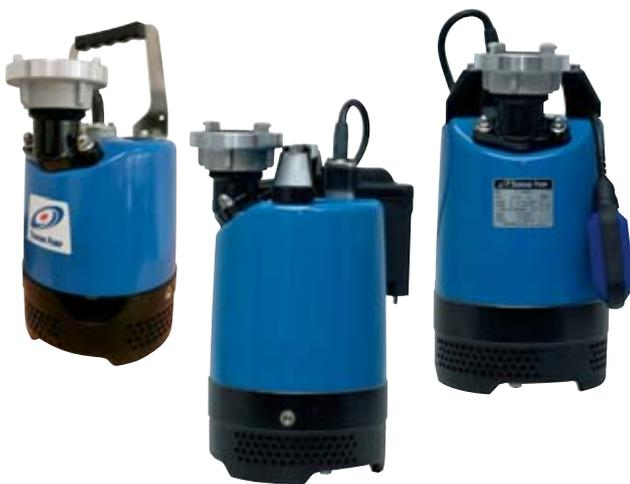
**Ausführung:** Robuste Schmutzwassertauchpumpe • Auslassöffnung oben • Trockenlaufsicher (halbgetaucht oder im Schlürfbetrieb) • Eingebauter Motorschutz • Schutzart **IP68**
