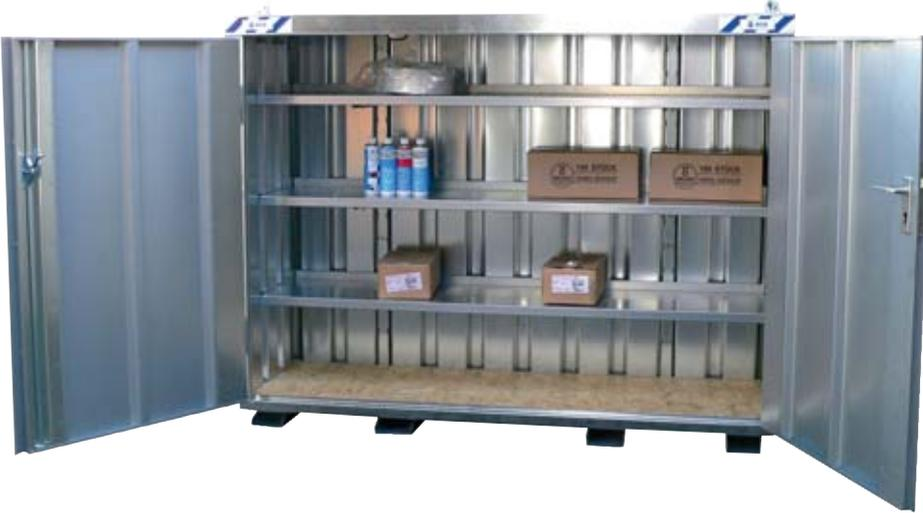
**Ausführung:** 4 Kranösen • **MB1 kranbar bis 300 kg, MB2 kranbar bis 600 kg** • Abstandhalter für Staplertransport und zur Bodenbelüftung • Schutzdecken für erhöhte Stabilität • **Türen:** 1-flügelig, 950 x 1390 mm, 2-flügelig, 1950 x 1390 mm • Schneelastsicherheit 210 kg/m<sup>2</sup> • Stabiler OSB-Holzboden • **Bodenbelastbarkeit 500 kg/m<sup>2</sup>**
