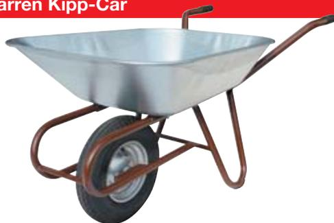
**Ausführung:** Mit nahtlos gezogener Mulde • Muldenrand mit ganzer Rundeiseneinlage verstärkt • Mulde verzinkt • Gestell braun lackiert • Befestigungsschrauben für Mulde versenkt • **Verstellbares Rad** (das Rad kann in 2 Aufnahmeschwerpunkte gelegt werden)
