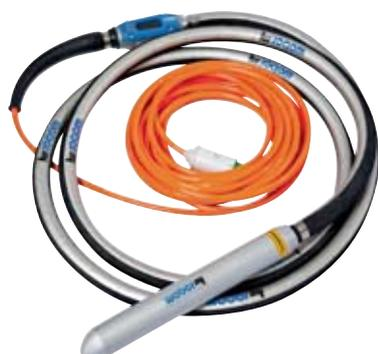
**Ausführung:** Für den Anschluß an Umformer mit 200 Hz/48 Volt • Mit 5 m Schutzschlauch und 15 m Anschlusskabel • Statorwicklungen vibrationsfest vergossen • Thermosensoren schützen vor dem „Verbrennen“ der Wicklungen • Gehärtete Flaschenrohre
